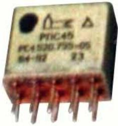
Слаботочное электромагнитное реле РПС 45 (РПС 45-1) является поляризованным двустабильным герметичным реле с двумя переключающими контактами и соответствуют ГОСТ 16121-86, ГОСТ ВД 16121-86 и техническим условиям ЯЛ0.452.081 ТУ.
